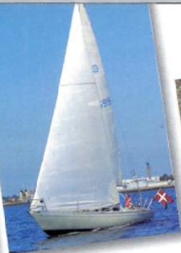
Shipman 28 har mastheadrig og gennævn er det primære sejl til at drive båden.
